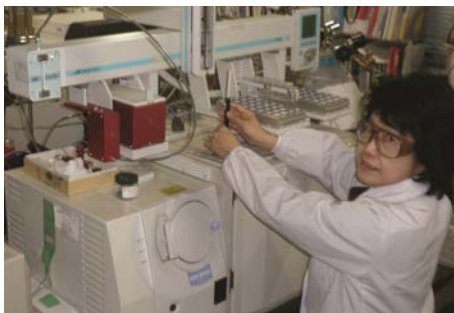
図1. GC-MSによるカビのニオイ分析
